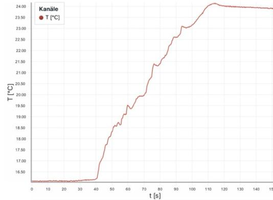
Man erhält eine Kurve ähnlich der nebenstehenden. Zunächst erkennt man den konstanten Verlauf am Anfang (Einstellzeit), dann die Aufnahme der Wärme der Verbrennung und dann das langsame Abklingen. Aus dem Diagramm oder der zugehörigen Wertetabelle lässt sich die Temperaturdifferenz für die kalorimetrische Berechnung bestimmen.
